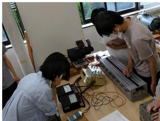
【電子制御実験2】(誘導電動機の特性実験)
