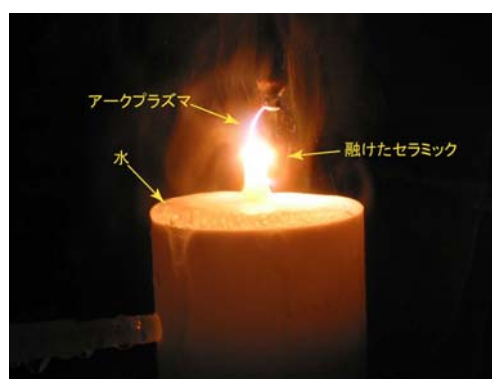
図 2 水/セラミック電極による放電の様子。
